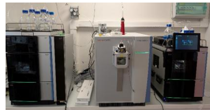
Fig. 1 Spectrométrie de masse à haute résolution (HRMS) à l'ITES de Strasbourg avec les éléments LC (à gauche, à droite) ainsi que le spectromètre de masse Orbitrap (au centre)
